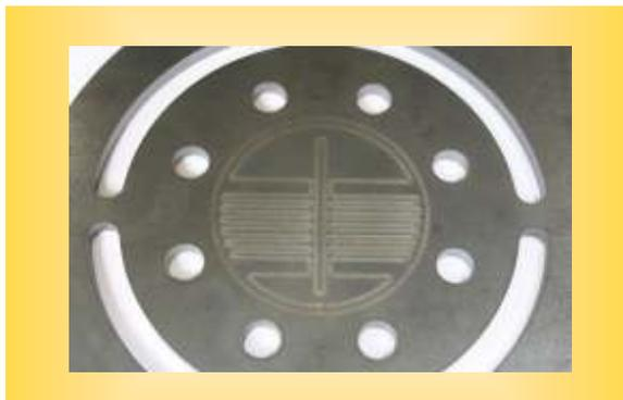
Die Brennerköpfe PerCut 370.1M und PerCut 370.2M ermöglichen das Schneiden, Markieren und Körnen ohne Verschleißteilwechsel.
