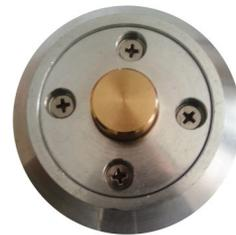
Bild 3. Werkzeuglängen Sensor
