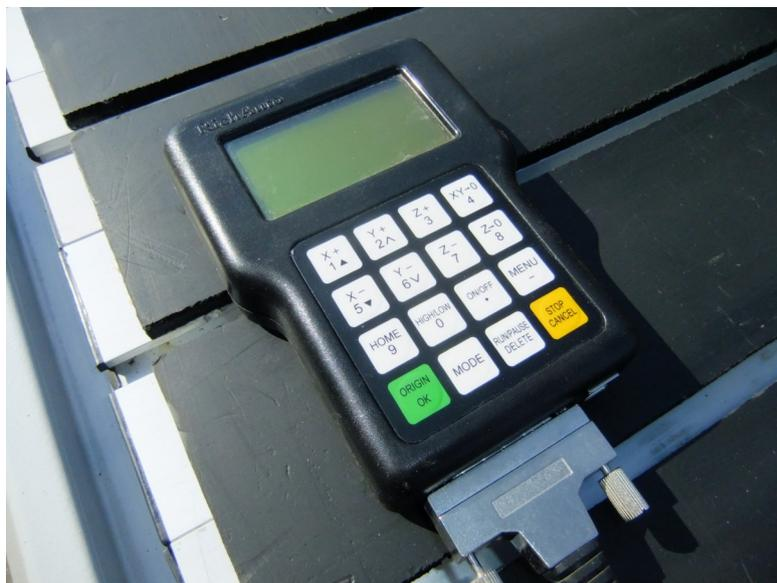
Bild 4. DSP Steuerung
