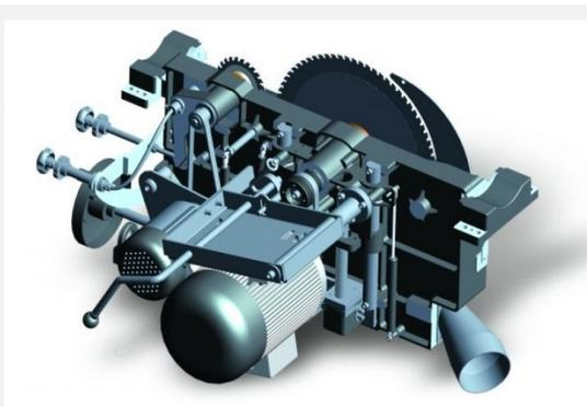
Grauss-Sägeaggrat mit doppelter Schwenksegmentführung - robust und verwindungssteif, leistungsstarker Drehstrom Motor 5,5 kW
