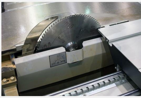
Sägeaggrat, max. Sägeblattdurchmesser 400 mm
