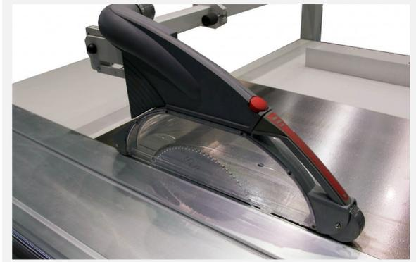
Parallelogramm Schutzhabe, wegschwenkbar
