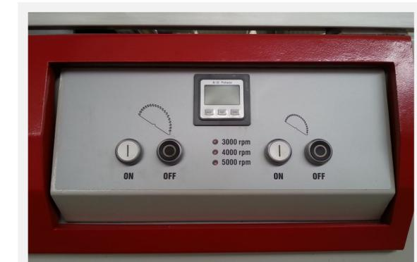
Bedienpaneel mit digitaler Gradanzeige und Drehzahlanzeige
