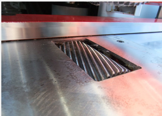
Pneumatischer Seitendruck vor der linken Welle Einzugswalze vor der Abrichtwelle
