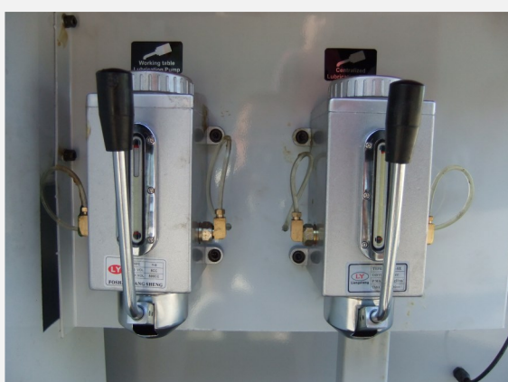
Schmier- und Gleitmittelpumpe
