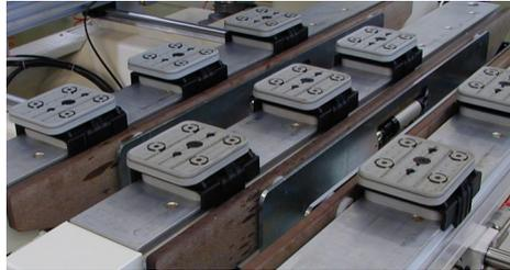
Bild 9. Werkstückauflagekonsolen
