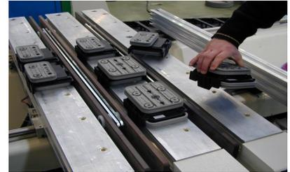
Bild 9a. Werkstückauflagekonsolen
