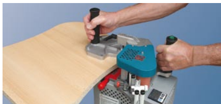
Beleimen von geschweiften und geraden Werkstücken
