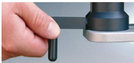
Einfaches Umstellen von Längskanten- zur Eckenbearbeitung.
