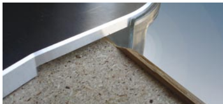
Gleichzeitiges Bündig- und Radiusfräsen der Längskanten in nur einem Arbeitsgang
