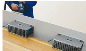
Spannen von großen Werkstücken in senkrechter Position.
