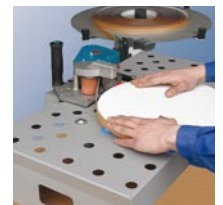
Beleimen runder Werkstücke mit SE2002
