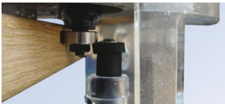
Absaugadapter mit Lagerbremse gegen Kratz- oder Brandspuren auf der Kante.
