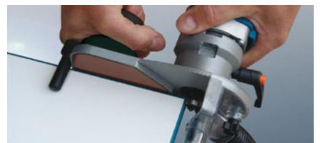
Präzise Führung zum Abrunden der Ecke.
