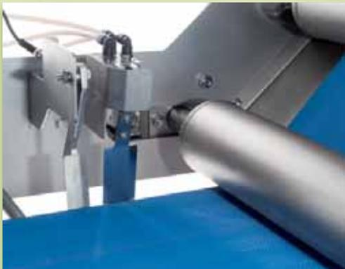
vollautomatische Bandlaufsteuerung und Not-Aus bei Bandverlauf
