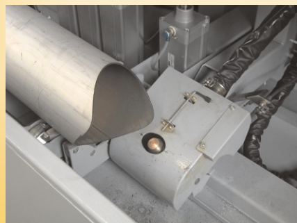
CrNi-Rohre (1.4301) mit metallisch blanken und bartfreien Schnittflächen
