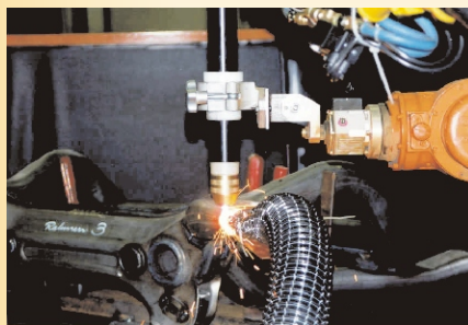
Endschnitt an einem geschweißten Fahrwerks- rahmen aus IHU-Profil
