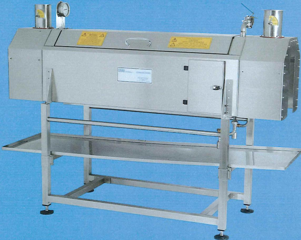
➤ Dieser Heißlufttunnel aus rostfreiem Stahl benutzt Dampf als Medium um Bänder oder Vollkörpersleeves zu applizieren.
