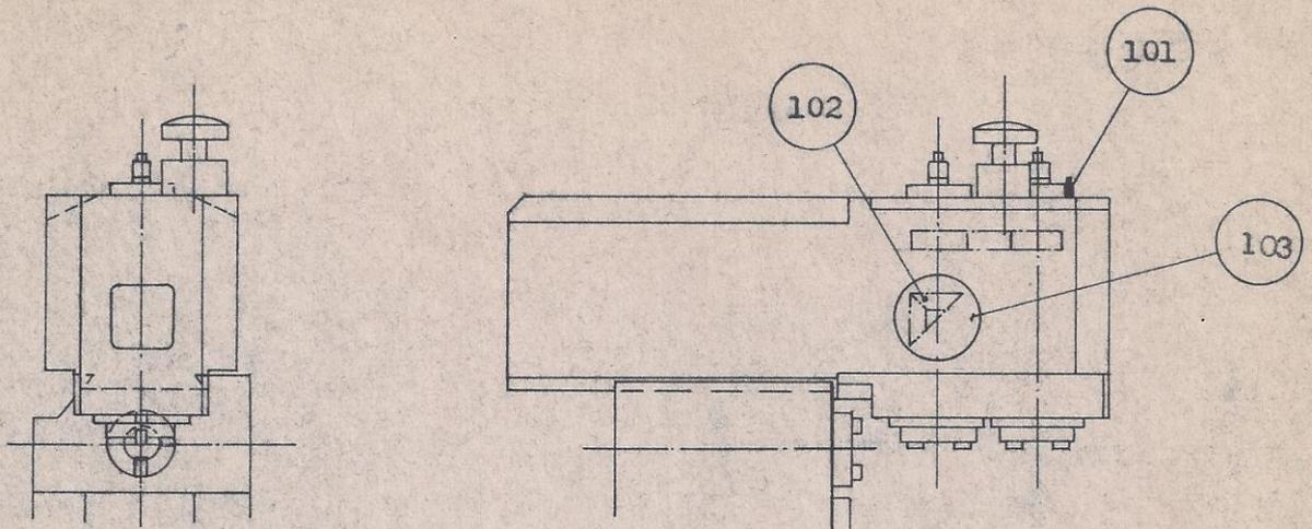
1. Die Frässpindellagerungen sind mit Klüber Fett Isoflex IDS 18<sup>z</sup> spezial geschmiert und deshalb wartungsfrei
