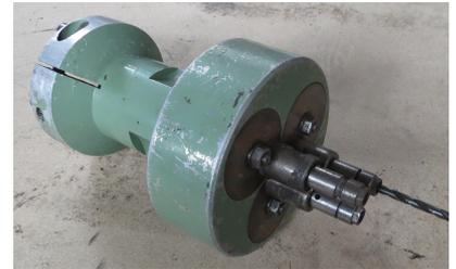
gebr. Mehrspindelkopf mit 3 Spindeln
