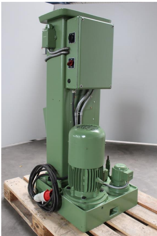
Maschinen Rückseite mit Hauptantrieb
