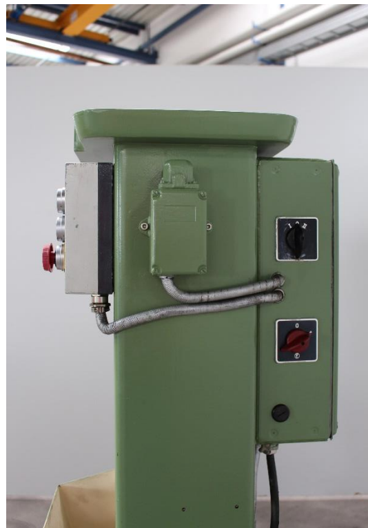
Schaltelement für Räumhub Verstellung
