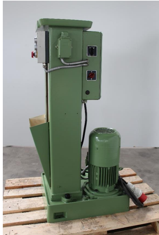
Ansicht Maschinenseite rechts mit mechanischem Hauptantrieb
