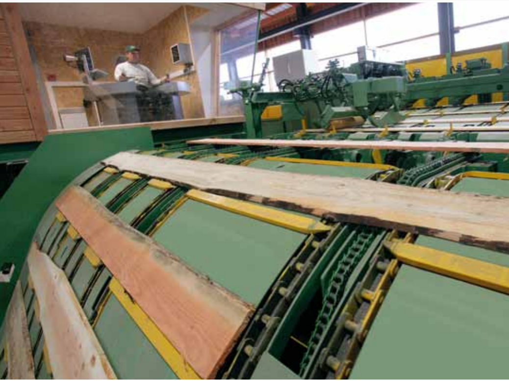
Bediener überblickt lückenlos die Brettmanipulation aus der vor Staub und Lärm geschützten Bedienerkabine
