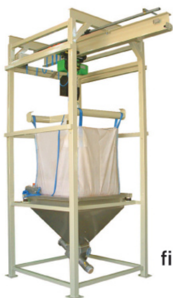
Stazione svuota Big Bag con paranco Bulk Bag emptying station with electric hoist
