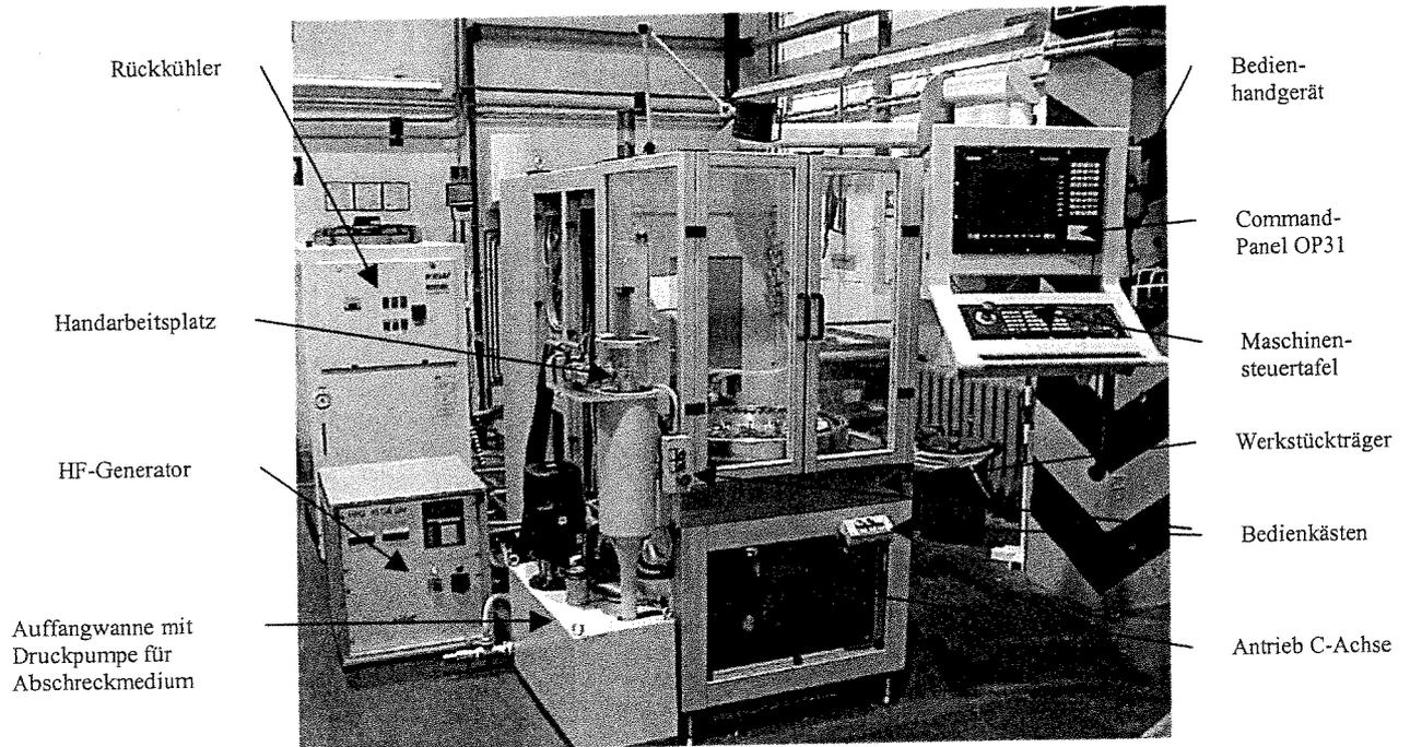
Abb. 1 Vorderansicht der Anlage
