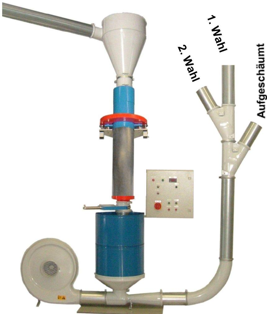
Das Gerät dient der Qualitätskontrolle von Granulaten. Durch ständiges Messen der Granulatdichte können die ersten Anzeichen von aufgeschäumtem Granulat erkannt werden. Das Gerät entscheidet nach den von Ihnen vorgegebenen Parametern und schaltet bei der Unterschreitung der Grenzwerte die Weichen zur 2. Wahl oder zum Ausschuss.
