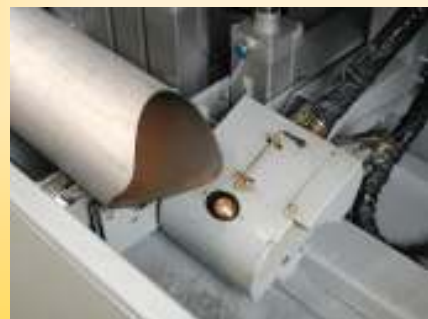
CrNi-Rohre (1.4301) mit metallisch blanken und bartfreien Schnittflächen
