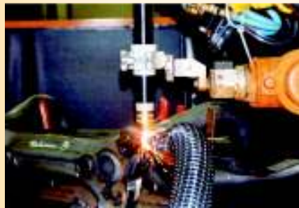
Endbeschnitt an einem geschweißten Fahrwerks- rahmen aus IHU-Profil
