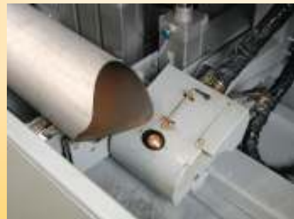
CrNi-Rohre (1.4301) mit metallisch blanken und bartfreien Schnittflächen
