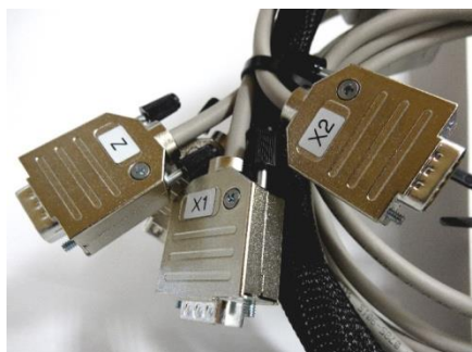
Abb. 13: Anschluss ST u. Motorleitung
