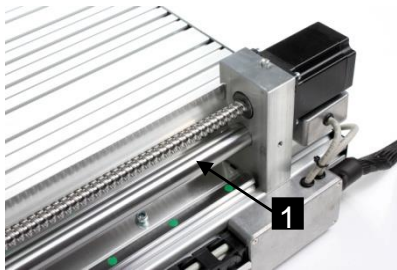
Abb. 28: Linearführungen der X- und Z-Achse
