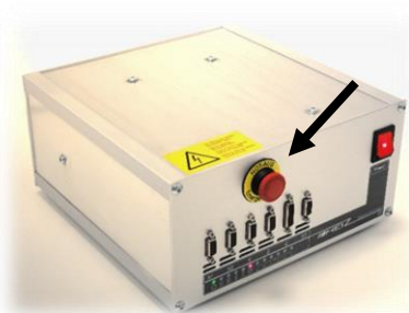
Abb. 3: Not-Aus-Taster an der Schrittmotorsteuerung (Zubehör)
