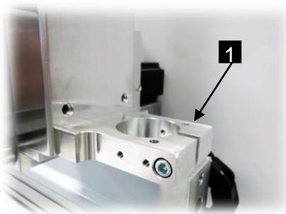
Abb. 11: Werkzeugaufnahme 43H7
