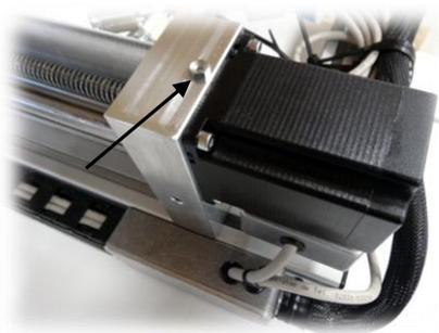
Abb. 31: Schmiernippel X-Achse
