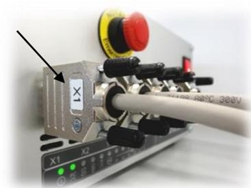
Die Stecker der Schrittmotor- und Steuerleitungen (Abb. 23 /Pfeil) sind beschriftet.
