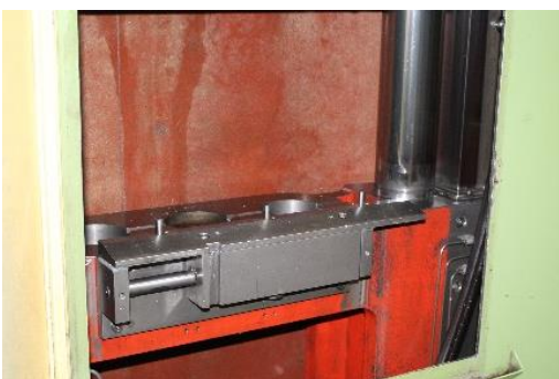
Ziehkopfbrücke mit hydraulischer Verriegelung Ø 100mm- Ø100mm- Ø100mm
