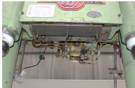
Unterseite hydr. Verriegelungssystem Werkzeugzubringer
