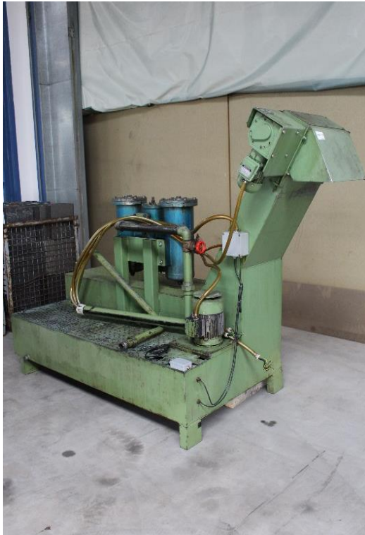
Kühlmittelanlage mit Späneförderer & Feinfilter
